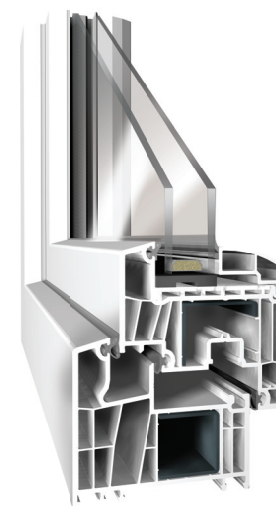
Pakiet 2 szybowy 24 mm ramka dystansowa SWISSPACER V, argon
