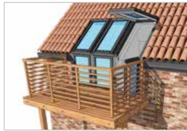
Okno balkonowe GEL/VEA/VEB/VEC w dachu ze ścianką kolankową
